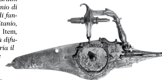
Piastra di accensione a ruota, ad un cane, per armi da fuoco del primo cinquecento (particolare). Il sistema è basato su un acciarino a forma di ruota con il bordo dentato; il meccanismo a molla viene caricato con una chiovetta; quando si aziona il grilletto, la ruota gira rapidamente in senso orario contro la pietra focaia, che strappa scintille di acciaio sufficienti ad accendere la polvere da sparo, posta al di sotto di essa. La prima rappresentazione di tale sistema si trova in un disegno di Leonardo da Vinci dell'inizio del '500.
